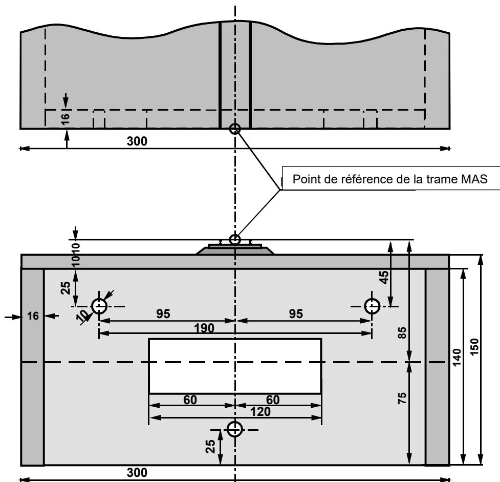
Liaison des modules : Pour relier les modules, on se sert de boulons M8 avec des écrous à ailettes et rondelles de 20 mm Ø au minimum. Les perçages de 10 mm Ø dans les planches de liaison permettent de compenser des petites différences en hauteur et en largeur.
